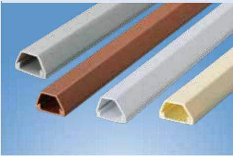
材質：UL合格之南亞PVC (灰色)，防火等級美規94V-0及歐規M1，PVC耐溫85°C。
