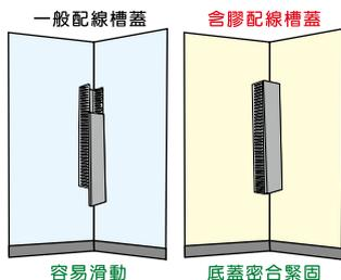
材質：UL合格之南亞PVC (灰色)，防火等級美規94V-0及歐規M1，PVC耐溫85°C，膠層為PE共聚物 (PE copolymer)。
