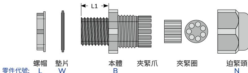
材質：UL合格之NYLON 66 (黑色)，防火等級 94V-2，夾緊圈為熱可塑彈性體(TPE)，墊片為PVC。
